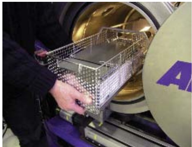
8 Einsetzen des befüllten Reinigungskorbes in den Autoklav
