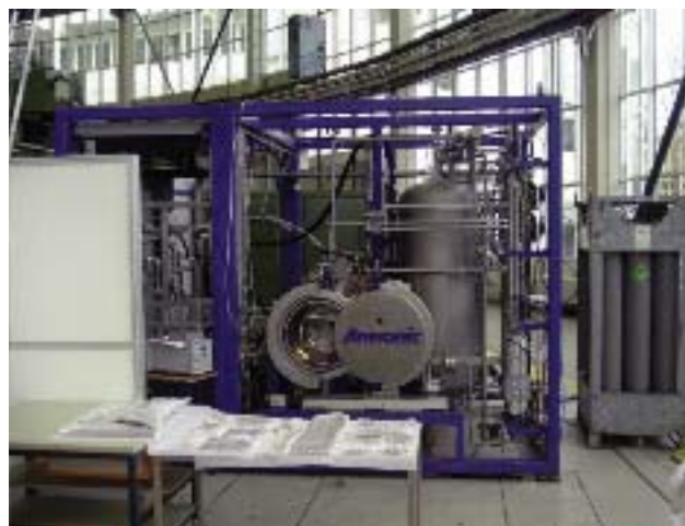
1 Ansicht der Amsonic economic liquid CO 2 -Reinigungsanlage mit eingehüllten Versuchsproben im Vordergrund
