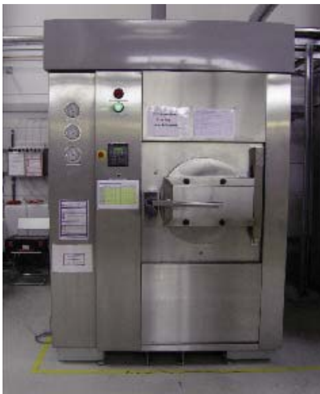
4 CO 2 -Reinigungsanlage Typ S 35 der Firma Cleaning Enterprises
